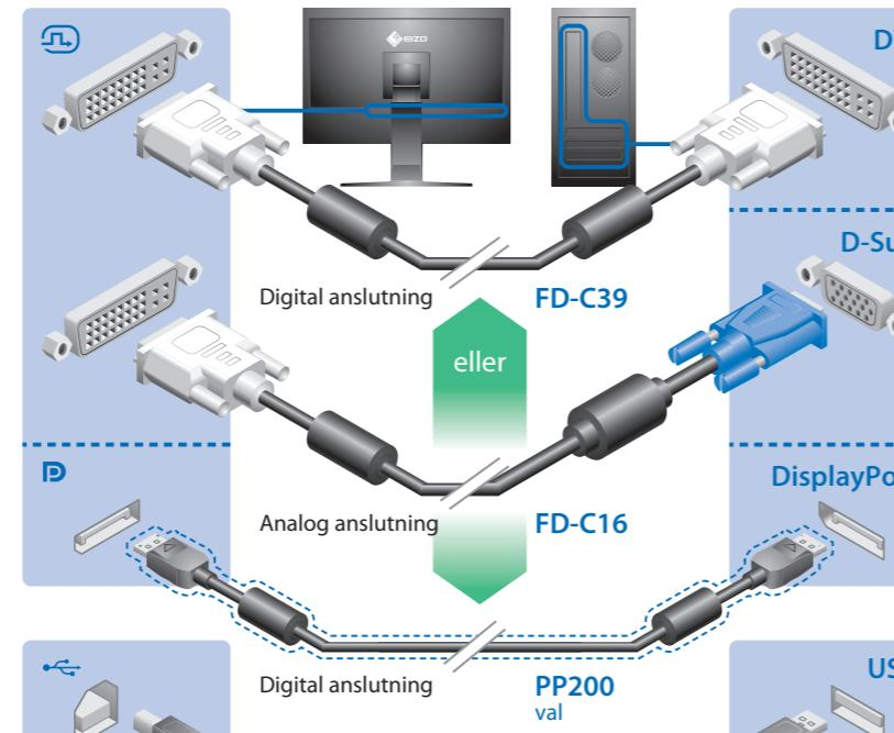
\*Det krävs USB-kabel för kalibrering. Försäkra dig om att du kopplar skärmen och datorn med USB-kabel.
