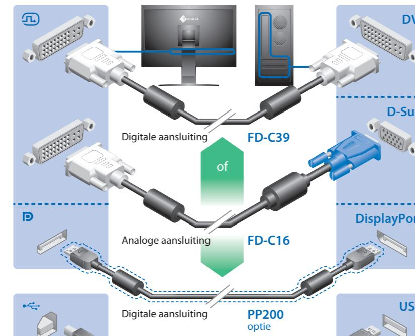
\*De USB-kabel is vereist voor het kalibreren. Zorg ervoor dat het beeldscherm en de computer zijn verbonden met de USB-kabel.
