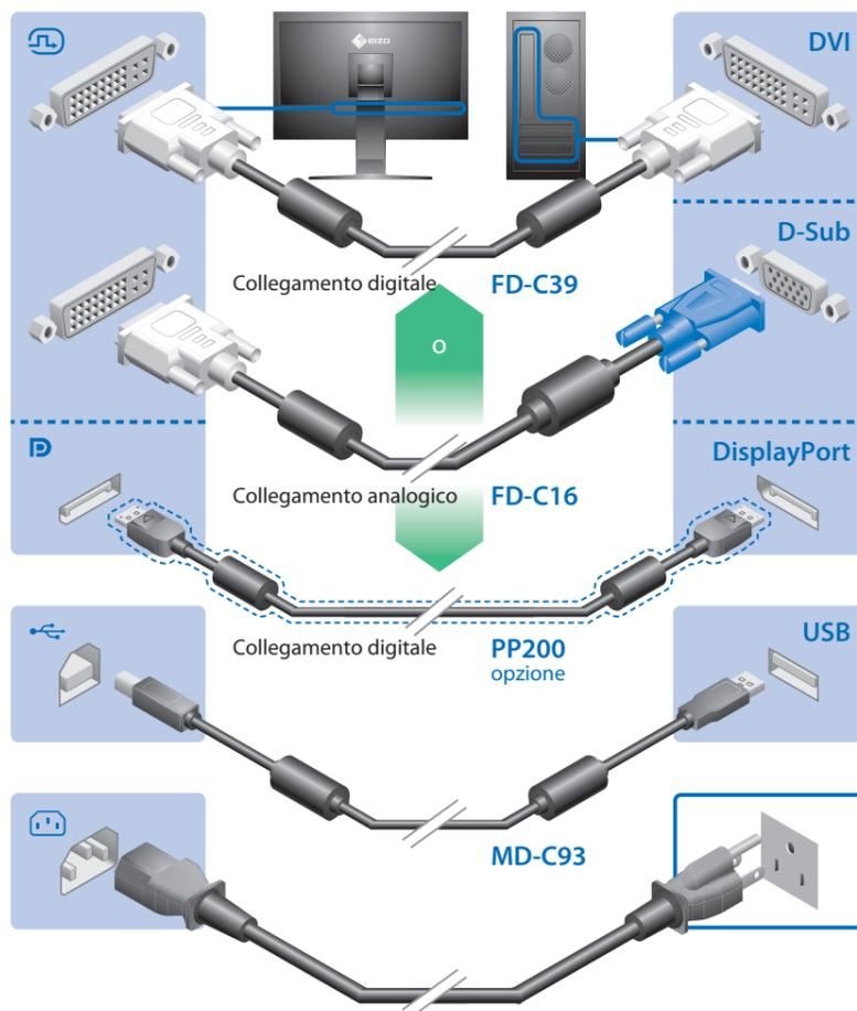
\*Il cavo USB è necessario per realizzare la calibratura. Assicurarsi di aver collegato il monitor e il PC con il cavo USB.
