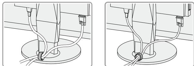
El portacables de la parte posterior del soporte mantiene los cables recogidos.
