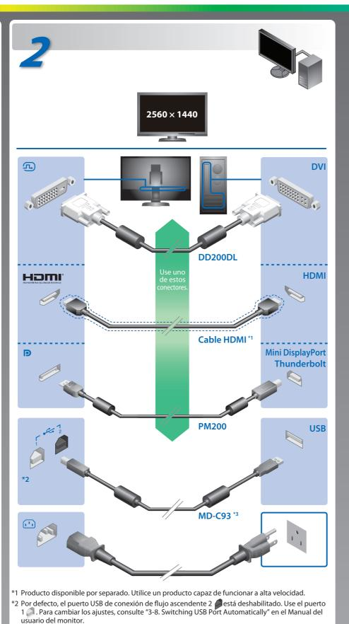
\*3 Para la calibración es necesario el cable USB. Compruebe que ha conectado el monitor y el
