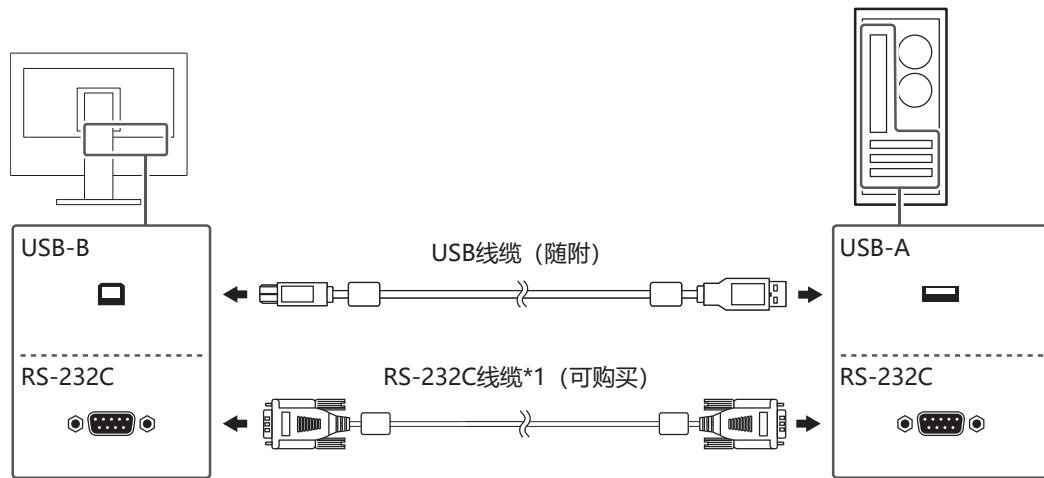
\*1 十字头式。显示器上的接口类型是D-Sub 9针。在默认设定中，禁用了RS-232C串行传输。有关如何更改该设定的详细信息，请参照用户手册中的“Administrator Settings菜单功能”。
