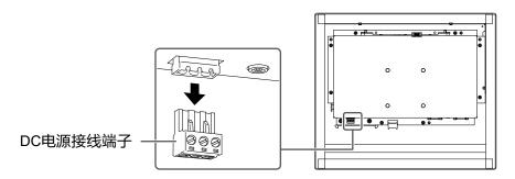
2. 剥掉电线表皮 (剥线长度:  $7 \pm 0.5 \text{ mm}$ )。 如果需要调整线头, 请连接杆状端子 (套管)。 请使用Phoenix Contact生产的套管。
