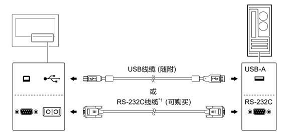
\*1 十字头式。显示器上的接口类型是D-Sub 9针。 默认情况下, RS-232C串行传输处于禁用状态。有关如何更改该设定的详细信息, 请参阅《用户手 册》中的 "4-2. "Administrator Settings" 菜单操作"。
