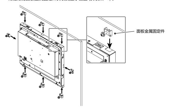
3. 在规定的扭矩(0.6 N·m - 0.7 N·m)拧紧面板金属固定件的螺丝,将其紧固。
