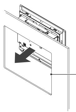
可安装面板开孔尺寸: 341 ± 0.5 mm × 289 ± 0.5 mm
